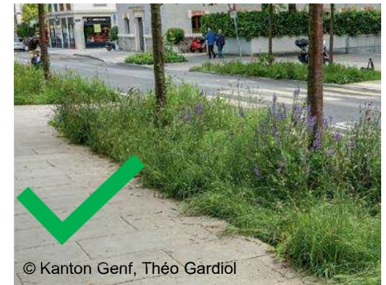
Strassenbegleitgrün absenken, erhöhte Randabschlüsse meiden
